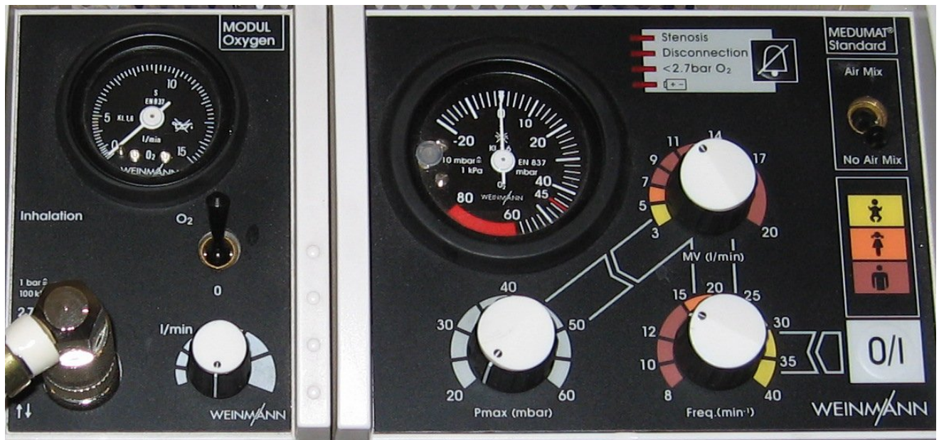
Abb. 102.17 – Bedienfelder Berieselungseinheit Modul Oxygen und Notfallbeatmungsgerät Medumat™ Standard. Modul Oxygen (li.): Flowmeter, Ein-Ausschalter und Regelventil. Der Anschluss links dient der Verbindung der Einheit mit dem Sauerstoffnetz des Fahrzeuges. Medumat™ Standard (re.): Air-Mix-Schalter, Ein-Ausschalter, Stellräder für Atemfrequenz, Atemminutenvolumen (!) und Druckbegrenzung, Beatmungsdruckanzeige, Warnleuchten für Verlegung (Stenosis), Lösung des Beatmungsschlauches (Disconnection), niederen Flaschendruck (< 2.7 bar) und schwache Batterie. . [Sebastian Gabriel, Lizenz: MfG]
