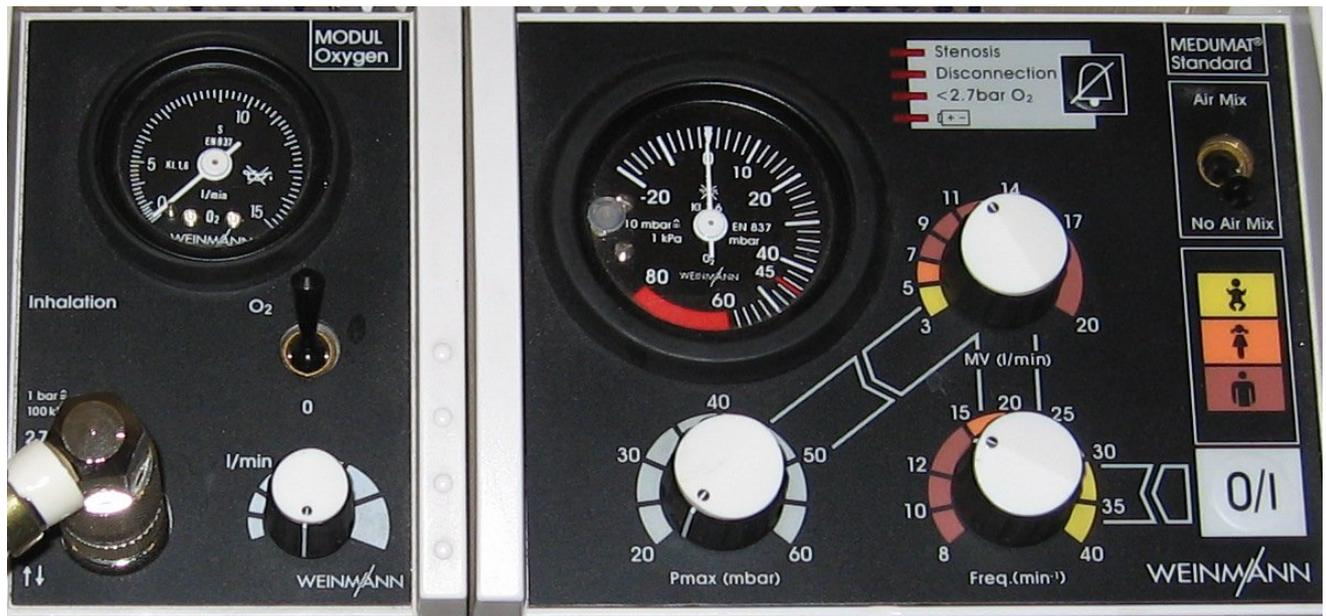
**Abb. 102.18** – Medumat Transport™. Dies ist ein Intensiv-Transportbeatmungsgerät, welches eine komplexe Beatmungstherapie ermöglicht. Die Bedienung erfolgt mittels Monitor und Drehräder. Abgebildet ist die Durchführung einer Funktionskontrolle der Bedienelemente.. [Christopf Pallinger, Lizenz: MfG]
