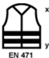
(a) Kennzeichnung der Warnschutzeigenschaften nach EN 471: X: Fläche an fluoreszierendem Material (1–3); Y: Fläche der Reflektorstreifen (1–2)
