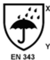
(b) Kennzeichnung der Schutzwirkung gegen Regen: X: Wasserdichtigkeit (1–3); Y: Atemungsaktivität (1–2)
